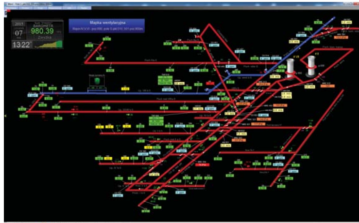
Rys. 7.2. Schemat fragmentu systemu wentylacji na kopalni Staszic
