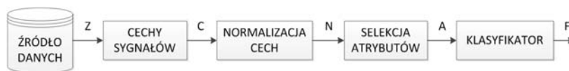
Rys. 10.2. Schemat ideowy sposobu pozyskiwania wiedzy z wykorzystaniem pojedynczego klasyfikatora działającego wg metody elementarnej
